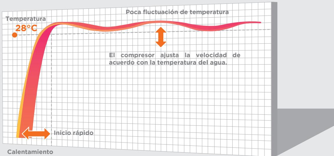
La **Tecnología Inter Heat Smart** permite por su funcionamiento obtener un rendimiento muy alto, debido a que baja las velocidades de su compresor, ahorrando en el gasto energético adicionalmente a la eficiencia de una bomba de calor convencional.
