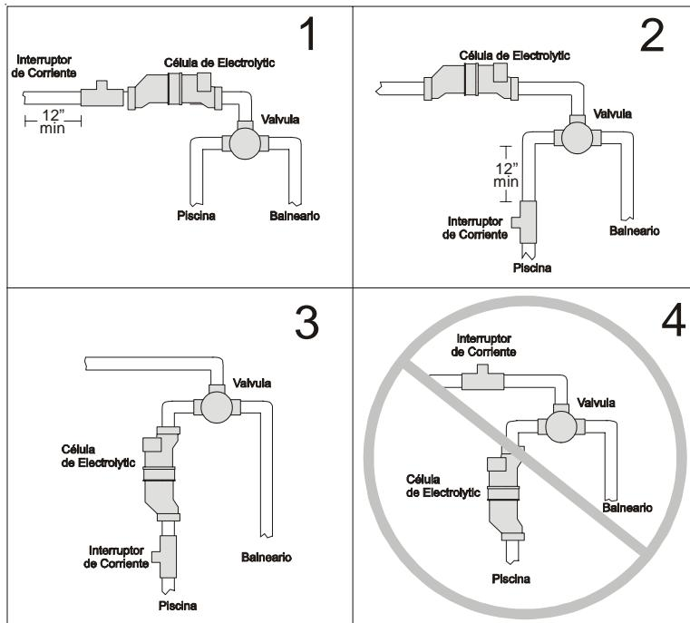
**Interruptor de corriente:** IMPORTANTE: Tiene que haber por lo menos 12" (25cm) de tubo recto que corra antes (río arriba) de el interruptor del flujo. Si el interruptor se plumbed después que la célula, la célula puede ser contado como 12" (25 cm) de tubo recto. Para asegurar la operación apropiada, verifique que la flecha en el interruptor del flujo (localizó encima del mal de ojo gris) los puntos en la dirección del flujo de agua.
